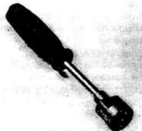
Инструмент для снятия шляпок пружин тормозных башмаков
