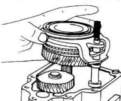
**10.10 Снятие всех групп синхронизатора 5-й передачи вместе с шестерней**
